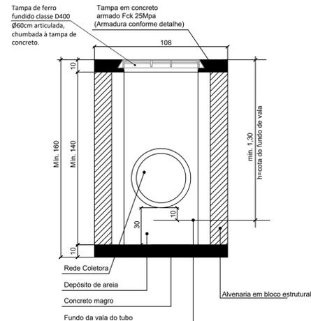
**DETALHE ARMADURA DA TAMPA
