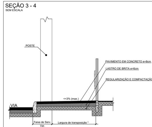
1 - DE ACORDO COM O ITEM 4.3.2 DA NBR 9050, QUANDO EXISTIREM OBSTÁCULOS ISOLADOS COM EXTENSÃO DE ATÉ NO MÁXIMO 40CM A LARGURA DE TRANSIÇÃO DEVE SER DE 90CM. QUANDO O OBSTÁCULO ISOLADO TIVER UMA EXTENSÃO ACIMA DE 40CM, A LARGURA MÍNIMA PARA TRANSIÇÃO DEVERÁ SER DE 90CM.
