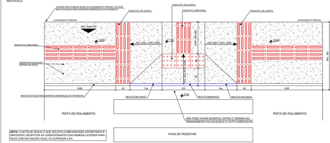
NOTA: O DETALHE SEGUIR O QUE SOLICITA A NBR 9050/2020. ENTRETANTO É IMPOSSÍVEL RESPEITAR AS CONDIÇÕES DAS RAMPAS LATERAIS PARA RUAS COM INCLINAÇÃO IGUAL OU SUPERIOR A 3%.
