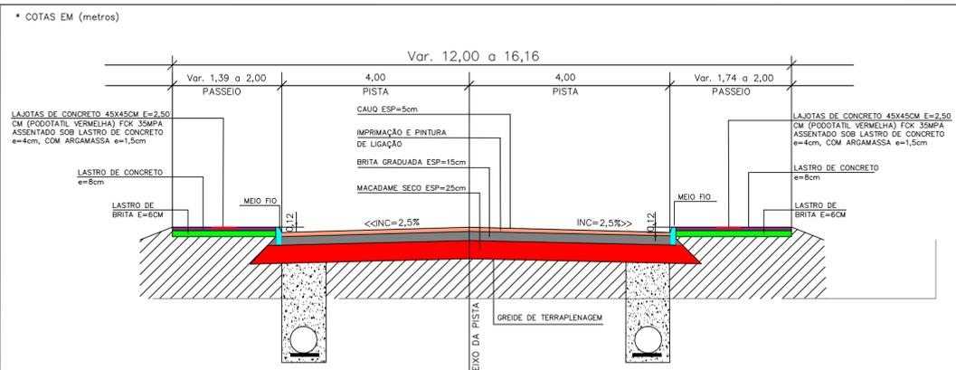
**SEÇÃO TIPO EM PAVIMENTO ASFÁLTICO PASSEIO NORMAL**
