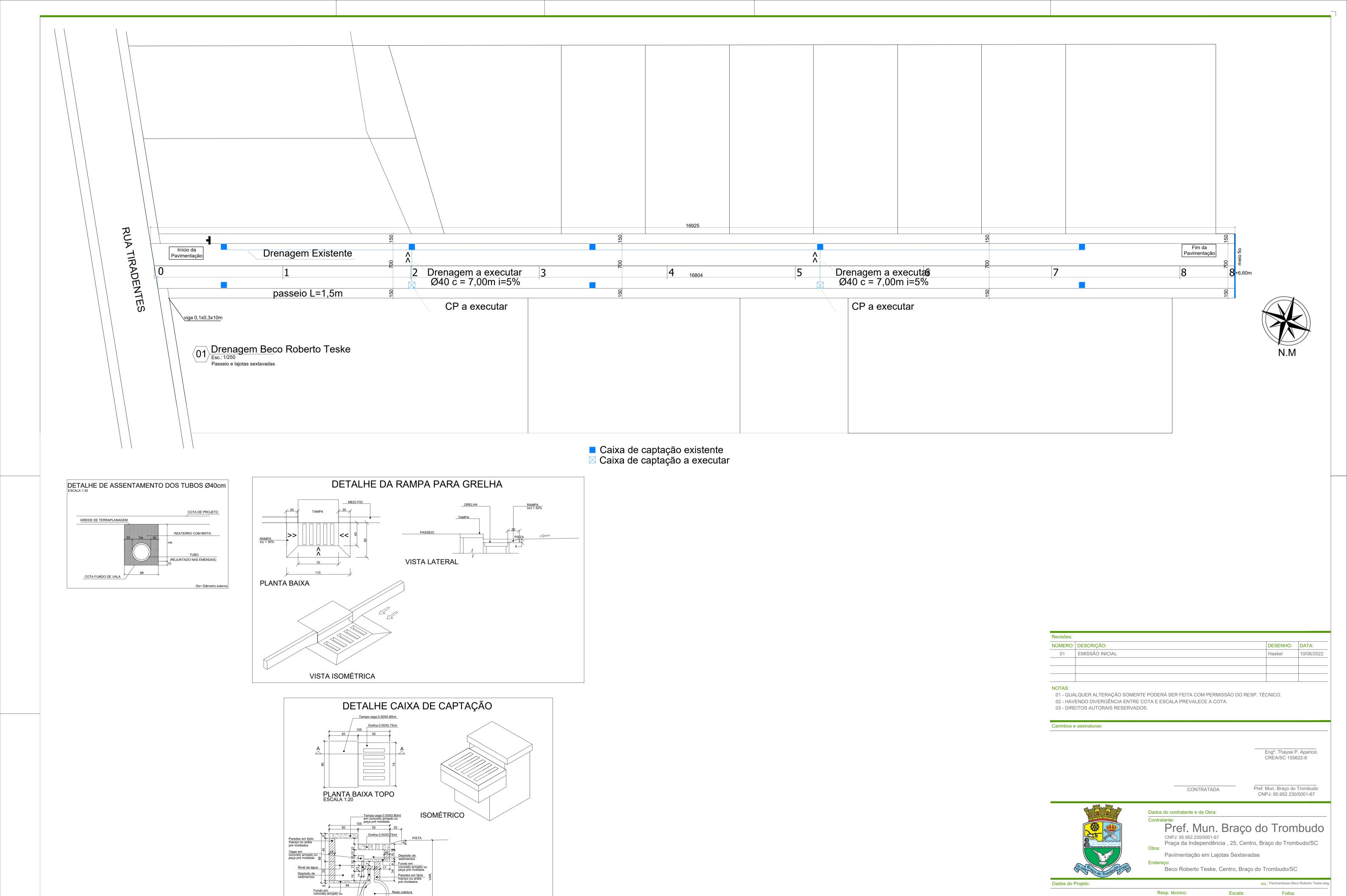
Para as tampas e fundos em concreto armado utilizar malha 10x10 Ø8mm
