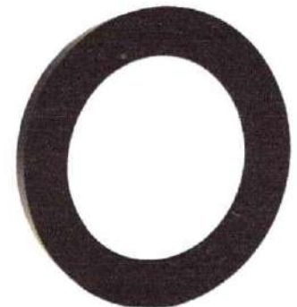
Retentor Nitrilico (NBR) Dureza 80 Shore (A), Suporta Até 90° C - 102X130X13MM
