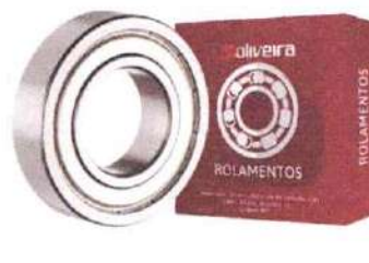
Rolamento Rigido de Esferas 6205-ZZ/C3 - 25x52x15mm
