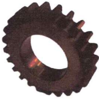
Engrenagem Recâmbio Torno Nardini - Z=24 - M2,25 - Furo 30mm
