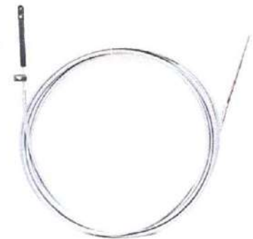
Cabo de Comando p/ Manete de Aceleração e Marcha - 12 pés Geração II Quicksilver
